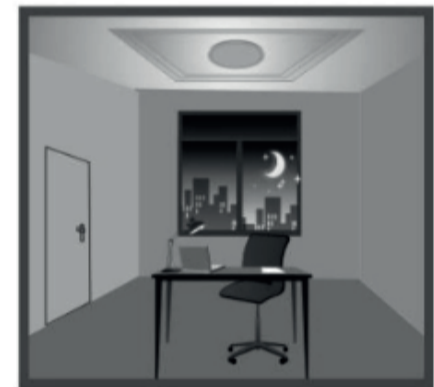
Efter en bestämd tid släcks armaturen om ingen rörelse uppfattas.
