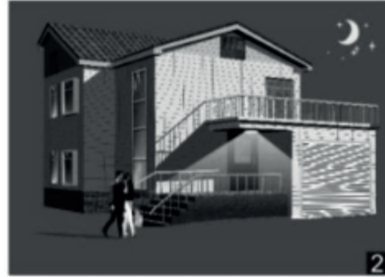
Rörelsedetektor tänds armaturen när det är mörkt ute.
