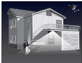
Rörelsedetektor tänder armaturen när det är mörkt ute.
