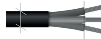
Ledararea: 0,5-0,75mm 2 Skallängd ledare: 5-15mm
