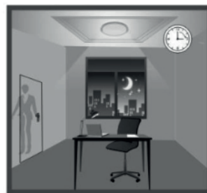
Efter en viss tid utan rörelse i rummet sänks ljusflödet från armaturen.
