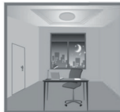
Efter en bestämd tid släcks armaturen om ingen rörelse uppfattas.
