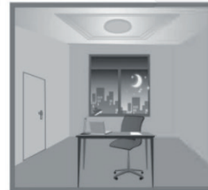
8 Efter en bestämd tid släcks armaturen om ingen rörelse uppfattas.
