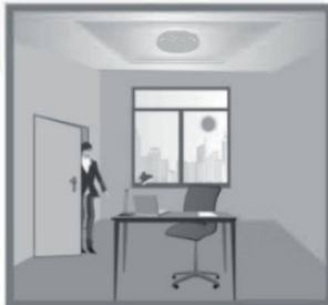
5 Då det är tillräckligt mycket dagsljus i rummet tänds inte armaturen.
