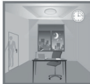
7 Efter en viss tid utan rörelse i rummet sänds ljusflödet från armaturen.
